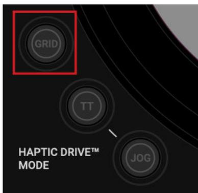
除了音轨的节拍，此时您还可以听到第二种拍子提示音(如同节拍器的嘀嗒声)，这个节拍用来表示Beatgrid。如果两个拍子提示音没有重合，说明Beatgrid设置有误。
